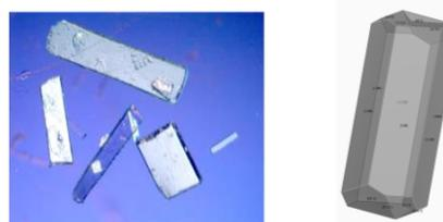
Figura 2: Comparação entre o cristal experimental obtido e morfologia calculada para o polimorfo II.
